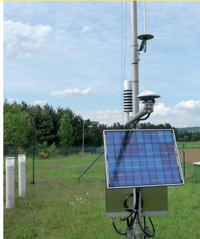
1 Die Waldklimastationen bestehen aus einer Bestandes- und einer Freilandmessstelle. Im Freiland werden z. B. wichtige Kenngrößen zu Wasserhaushalt, Globalstrahlung oder Verdunstung erhoben. Foto: S. Raspe, LWF
