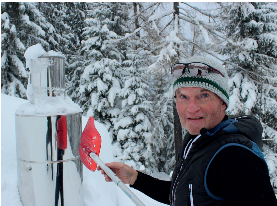
Die Depositionssammler auf der Freifläche wie auch im Waldbestand werden jede Woche beprobt. Foto: D. Köhler, LWF
