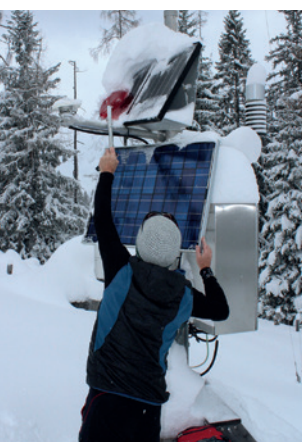
Die Reinigung der Solarpanels gehört genauso zu den Aufgaben eines WKS-Probennehmers wie der prüfende Blick in den Elektronikkasten.
