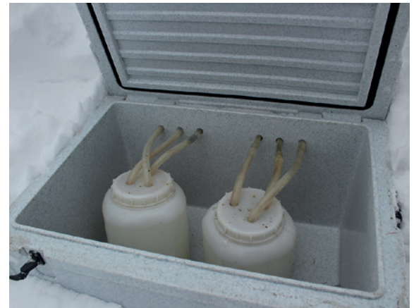
Kiste mit den Sammelbehältern, in die die Humuslösung aus den Humuslysimetern geleitet werden. Foto: D. Köhler, LWF
