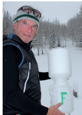
Die Depositionssammler auf der Freifläche wie auch im Waldbestand werden jede Woche beprobt. Foto: D. Köhler, LWF
