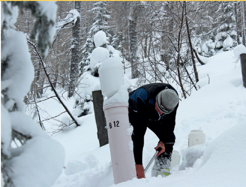
Im Winter Routine: Die Depositionssammler müssen vom umliegenden Schnee freigeschaufelt sein, um das Verschieben der Sammler möglichst zu vermeiden. Foto: D. Köhler, LWF
