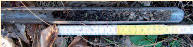
Abbildung 2: Im Bohrstockprofil ist die Flachgründigkeit des Standorts zu erkennen. Unter der Humusauflage steht bereits kalkhaltiges Lockergestein an. Die aufstockenden Kiefern weisen Nadelvergilbungen und -verluste aufgrund von Eisenmangel auf.
