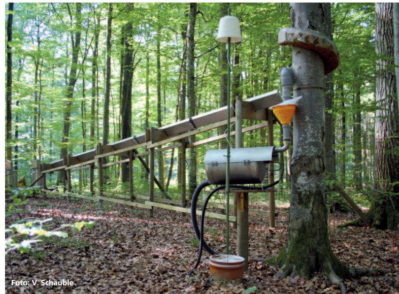
Abbildung 5: Auffangvorrichtung mit Kippwaage zur Messung des Stammabflusses sowie Rinne zur Messung des Kronendurchlasses (Hintergrund), WKS Freising
