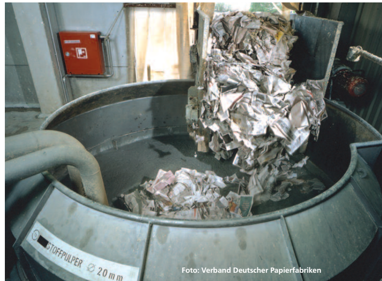
Abbildung 3: Im Stoffpulper wird das Altpapier in Wasser aufgelöst und zerfasert.
