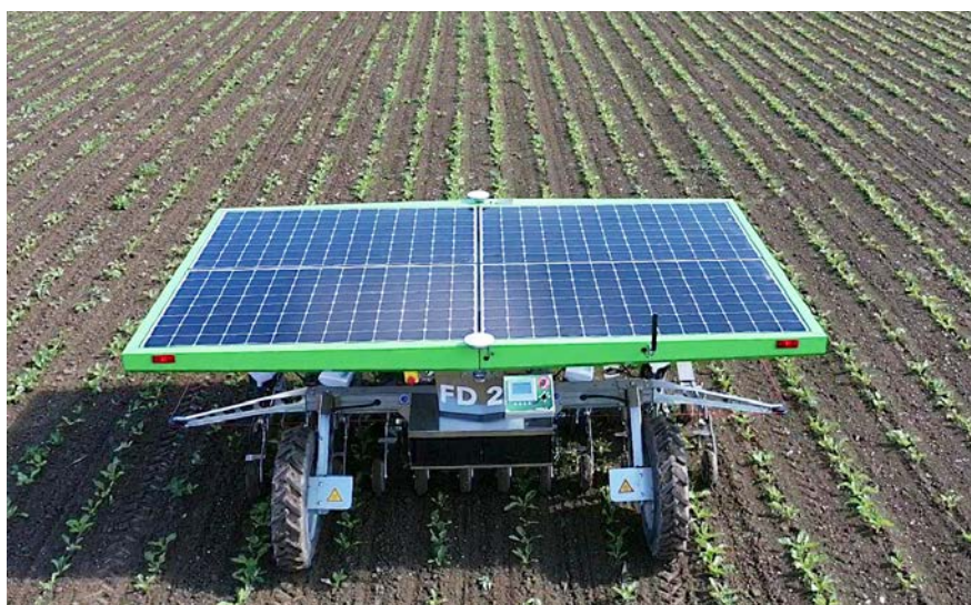
Bild: Feldroboter FarmDroid FD20 zur autonomen Aussaat und mechanischen Unkrautregulierung zwischen und in den Reihen bei Zuckerrüben (Foto: Stefan Kopfinger, LfL)
