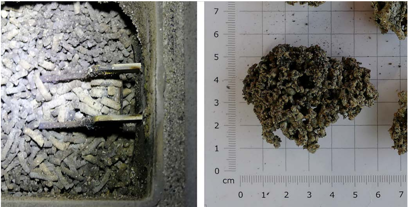
▭ Bild 2: Pelletförmige Schlackepartikel nach der Verbrennung von Rohrkolben auf dem Rost des 15 kW Pelletkessels (links) und Schlackebrocken aus Rohrglanzgras aus demselben Kessel (rechts), jeweils ohne Additiv (Fotos: TFZ)
