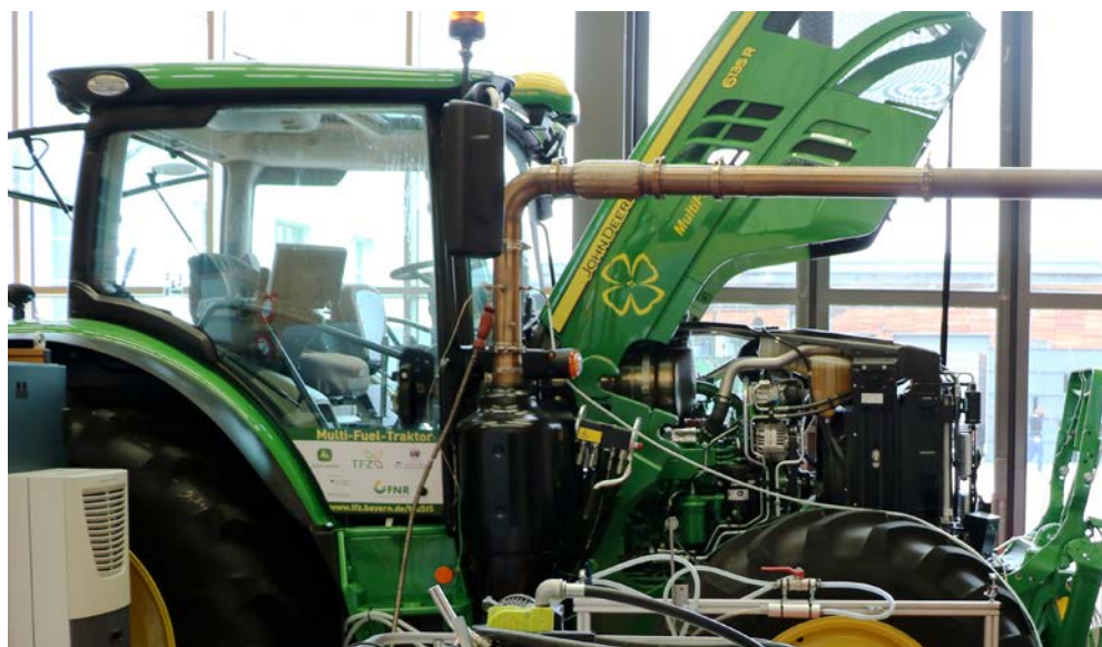
▢ Bild: Multifuel-Forschungs-Traktor John Deere 6135R der Abgasstufe V für Diesel, Biodiesel und Rapsölkraftstoff am Traktorenprüfstand des TFZ (Foto: TFZ)
