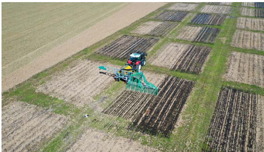
▭ Bild 1: Ausbringung unterschiedlicher Gärrestmengen auf die Versuchspartellen mit einem Parzellengüllefass mit Schleppschlauchverteiler (Fotos: TFZ)
