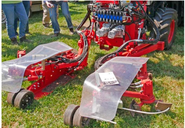
Bild 2: Zweiseitiger Krümler, der Baumstreifen links und rechts gleichzeitig bearbeiten kann
