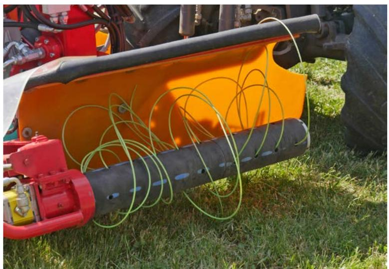
Bild 3: Mit den langen Fäden wird unerwünschter Aufwuchs oberflächlich abgeschlagen
