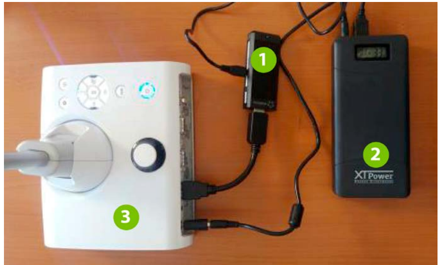
▣ Bild 1: Sende-Einheit 1 zur Bildübertragung am HDMI-Ausgang der Dokumentenkamera – Powerbank 2 zur Stromversorgung für die Doku-Kamera 3 und die Sende-Einheit (Fotos: Peter Weyman)
