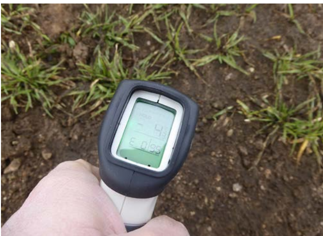
Bild 1: Für die Prüfung der Aufnahmefähigkeit des Bodens wird die Oberflächentemperatur gemessen (alle Fotos: AELF Amberg)
