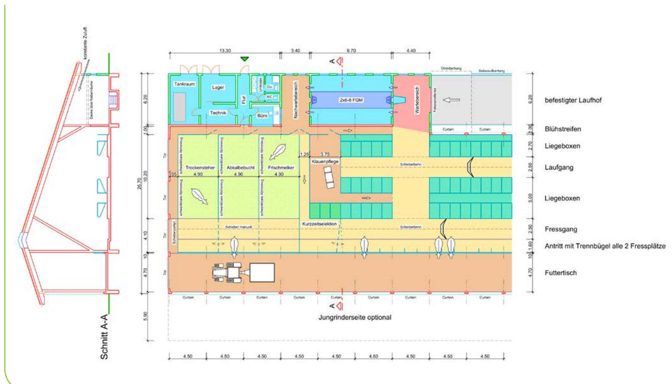
Abbildung: Entwurfskonzept mit Integration der Sonderbereiche, Bauberater Wolfram Wallner, FZ 3.6 AELF Kaufbeuren
