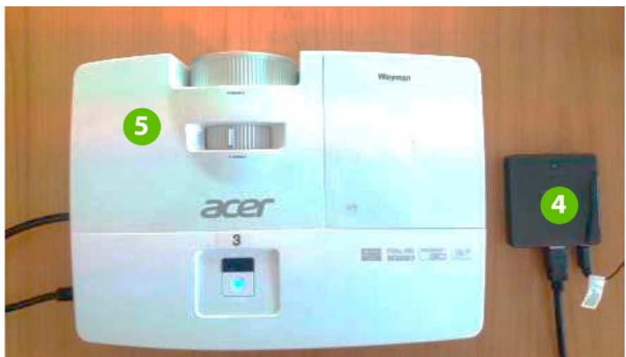
▣ Bild 2: Die Empfänger-Einheit 4 zur Bildübertragung wird am HDMI-Eingang vom Beamer 5 angeschlossen. Die Empfänger-Einheit wird über ein mitgeliefertes Netzteil mit Strom versorgt
