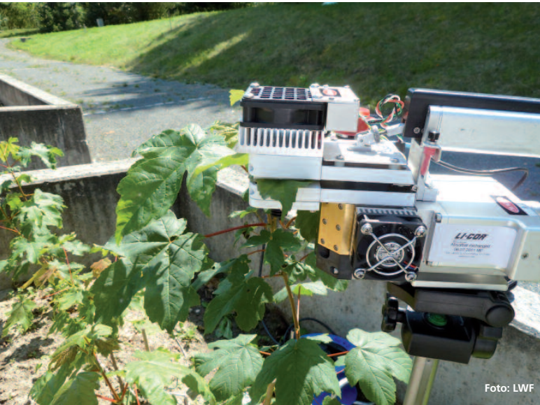
Abbildung 2: Messzange des Porometers mit Bergahornblatt in der Messkammer
