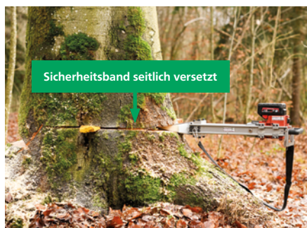
Abb. 1: Mechanischer Fällkeil im Schnabelschnitt.
