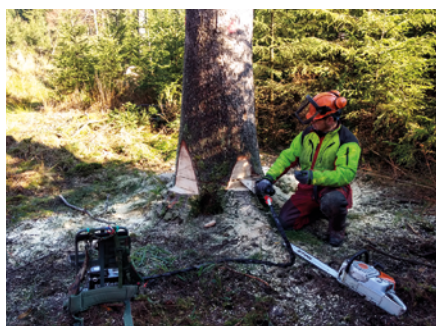
Abb. 2: Fernbedienbarer hydraulischer Fällkeil.
