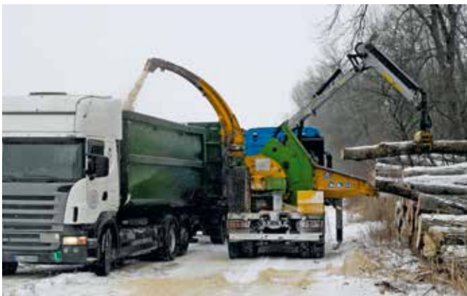
Maschinenaufstellung bei ausreichender Wegebreite
