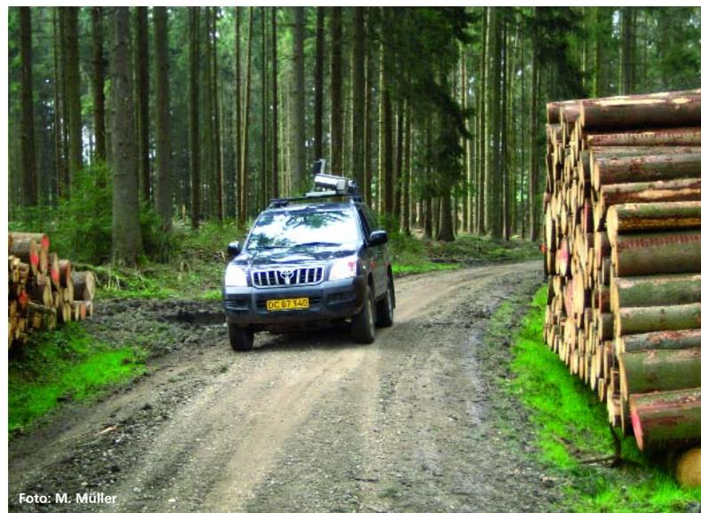
Abbildung 1: Mit einer Geschwindigkeit von etwa 10 km/h fährt das Dralle-Mobil an dem aufzunehmenden Holzpolter vorbei.
