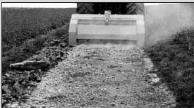
nach Bedarf kann er ein ebenes, schräges oder dachförmiges Profil erstellen. Als letzten Arbeitsschritt verdichtet die heckseitig angebrachte Vibrations-Verdichterplatte den Weg.
