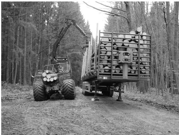
Abb. 1: Trailerdirektbeladung mit Forwarder
