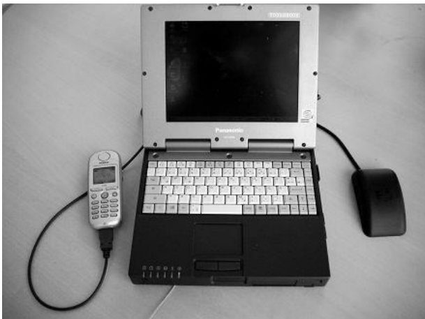
Abb. 1: Laptop mit GPS-Antenne und Mobiltelefon zur Datenübertragung (Foto: von Bodelschwingh)
