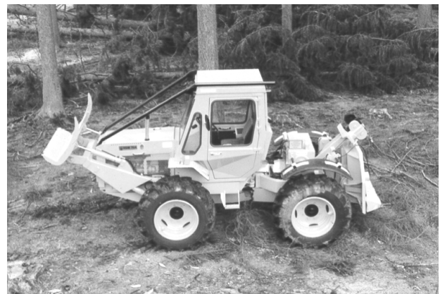
Abb. 2: In den 1980ern kamen Forstspezialschlepper auf, hier Knickschlepper (Skidder, Foto: Archiv Lehrstuhl für Forstliche Arbeitswissenschaft).
