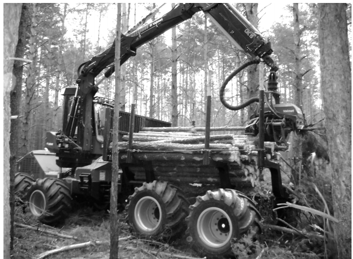
Abb. 1: Direkte Aufarbeitung in die Rungen mit Valmet 801 Combi (Foto: von Bodelschwingh)
