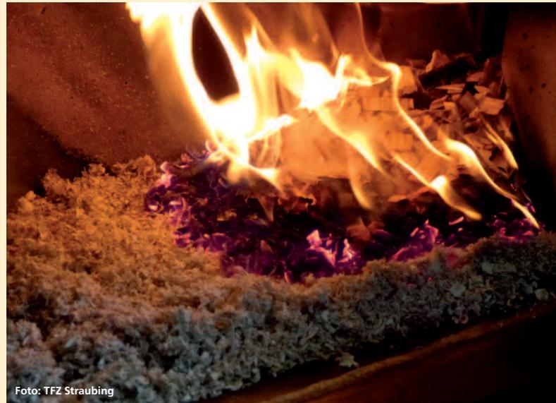
Abbildung 2: Im Rahmen des TFZ-Projekts werden Feuerungsversuche mit Hackschnitzeln verschiedenster Brennstoffqualität durchgeführt, um dabei den Wirkungsgrad und die bei der Verbrennung entstehenden Emissionen zu messen.
