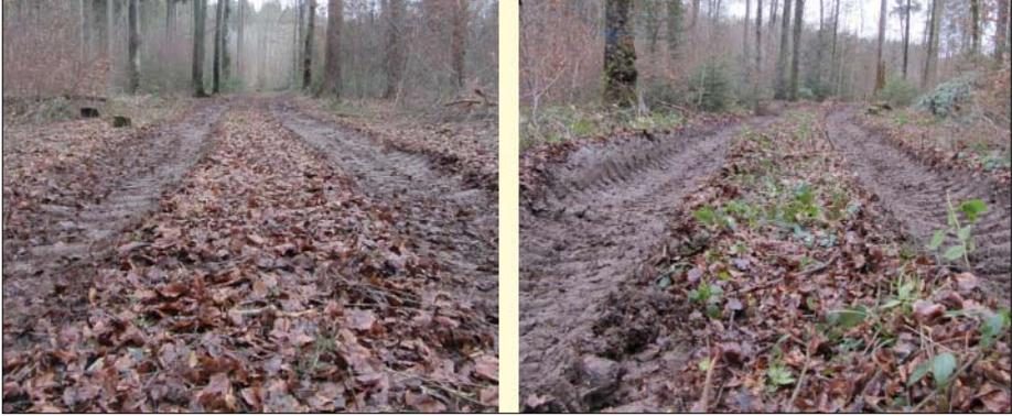
**Abb. 3: Fahrspurausprägung bei 1,8 bar (links) und 4,0 bar Reifeninnendruck. Bodenfeuchte 36 %.**
