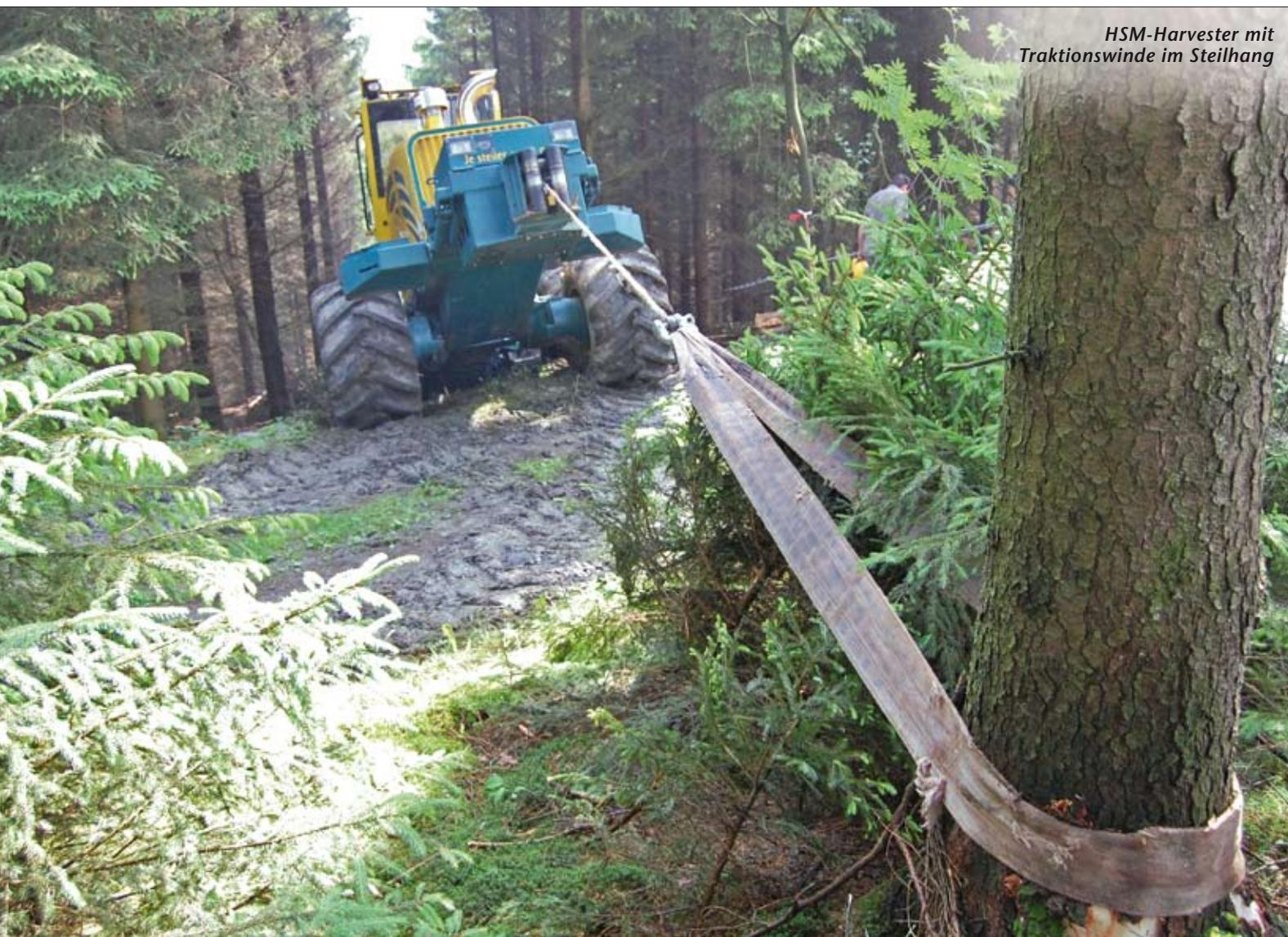
*HSM-Harvester mit Traktionswinde im Steilhang*
