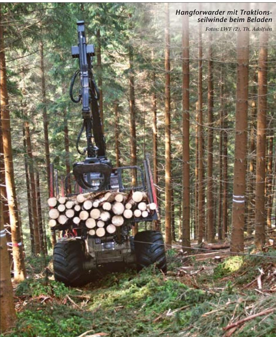
*Hangforwarder mit Traktionsseilwinde beim Beladen*
