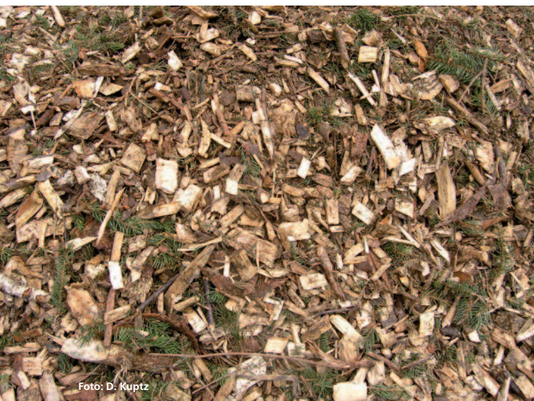
Abbildung 1: Für jede Feuerung geeignet? Hackschnitzel aus Waldrestholz (hier Fichte) haben hohe Anteile an Nadeln, Rinde und Ästen.
