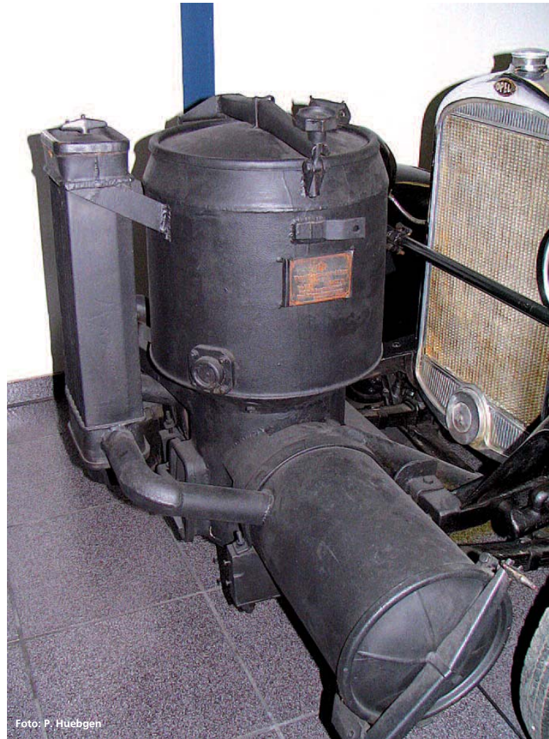
Abbildung 2: Holzvergaser an einem Opel P4 (1940)
