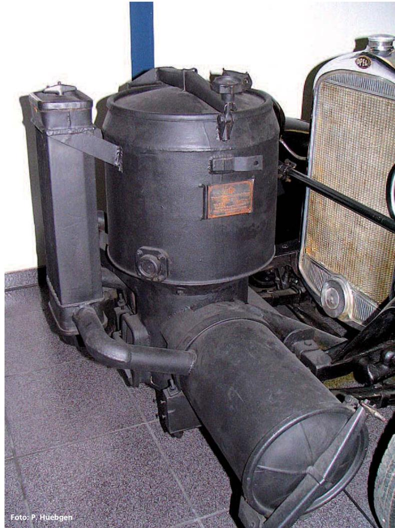
Abbildung 2: Holzvergaser an einem Opel P4 (1940)
