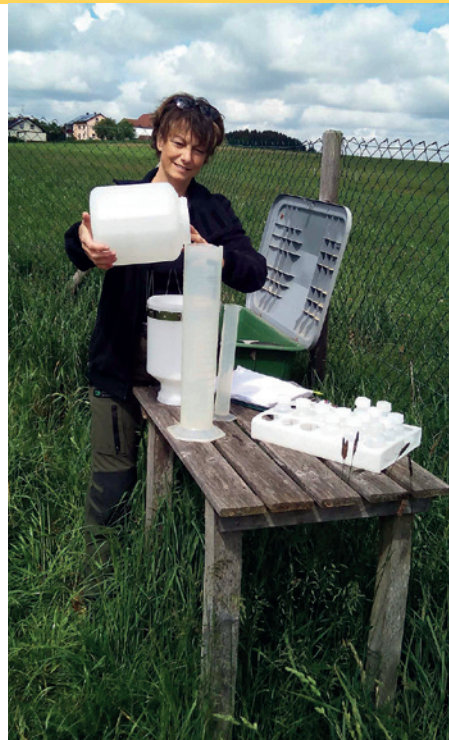
7 Auch auf den Freilandmessstellen der Waldklimastationen werden Stickstoff und andere Schadstoffe gemessen, die mit dem Niederschlag oder als Stäube in den Wald eingetragen werden. Die Probennehmerin der WKS Högwald, Eva Rusch, leert einen Depositionssammler auf der Freilandmessstelle.
