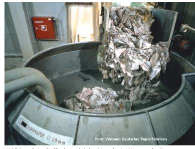
Abbildung 3: Im Stoffpulper wird das Altpapier in Wasser aufgelöst und zerfasert.
