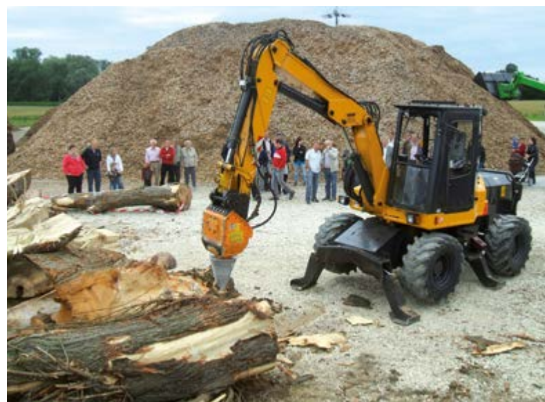
Die Zuschauer sind beeindruckt: Das Schneckengewinde des Kegelspalters wird auch mit extrem dicken Stämmen fertig.
